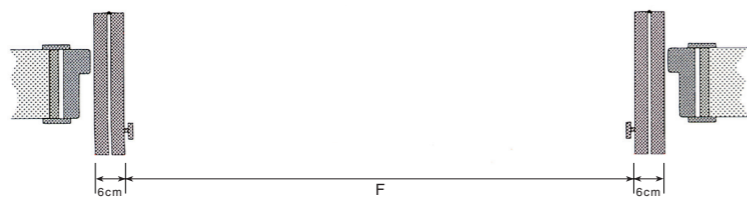
NIEDER2 a quattro ante, schema di apertura ante - Four leaves NIEDER2, door opening diagram
